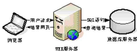
图 3 B/S 三层结构工作原理
