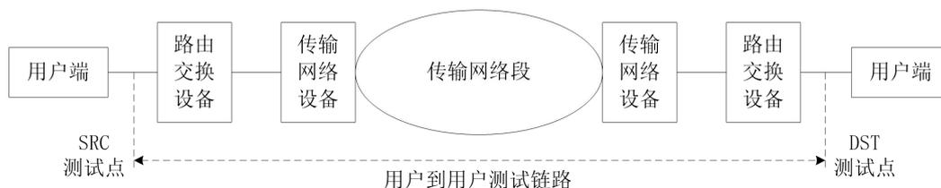
图 T 8004-2 用户到用户测试链路示意图
